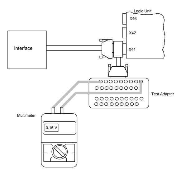
X41 : PLC output X42 : PLC input
